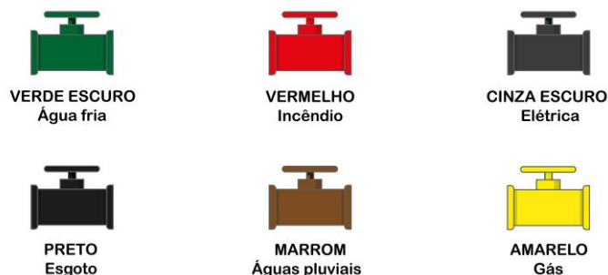
Figura 26 - Cores das tubulações
