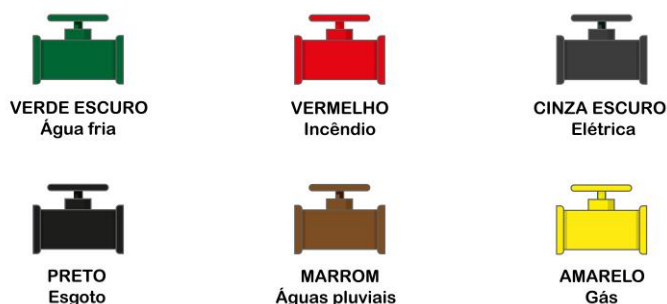
Figura 11 - Cores das tubulações
