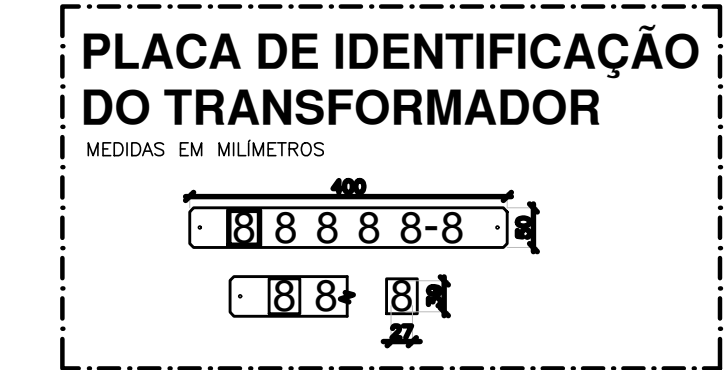
PLACA DE IDENTIFICAÇÃO DO TRANSFORMADOR MEDIDAS EM MILÍMETROS
