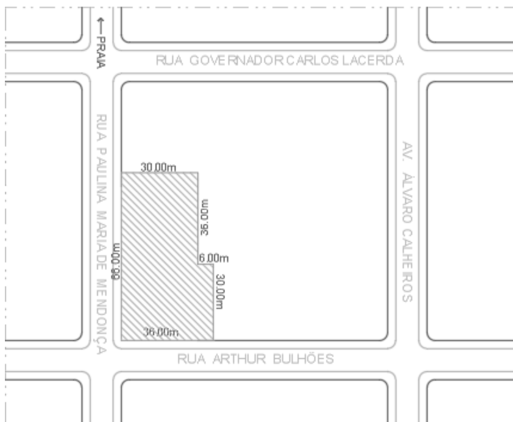
Figura 2 – Planta de Situação do Edifício Syrah
