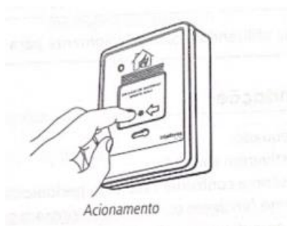
Figura 33 - Botoeira de incêndio
