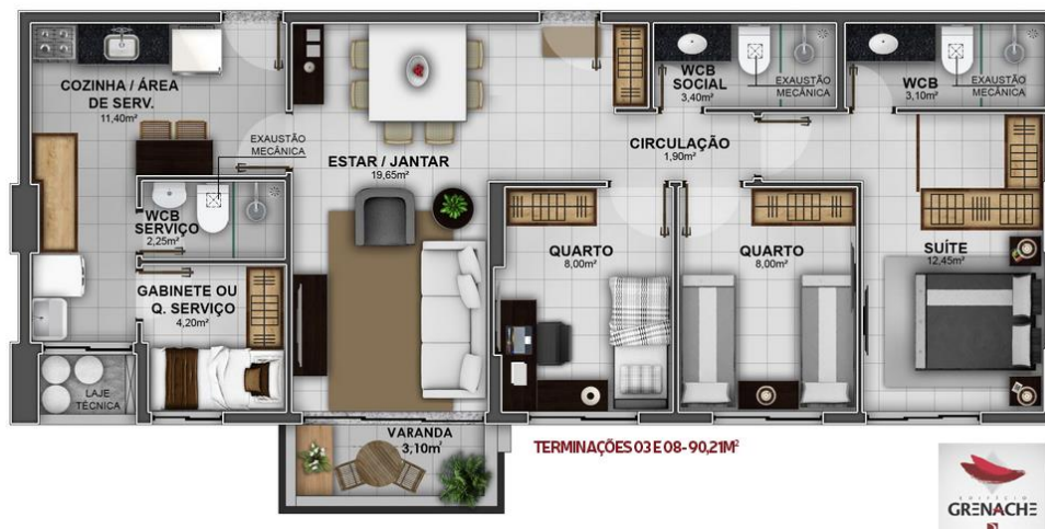
Figura 9 - Planta baixa dos Apartamentos Tipo com terminações 03 e 08
