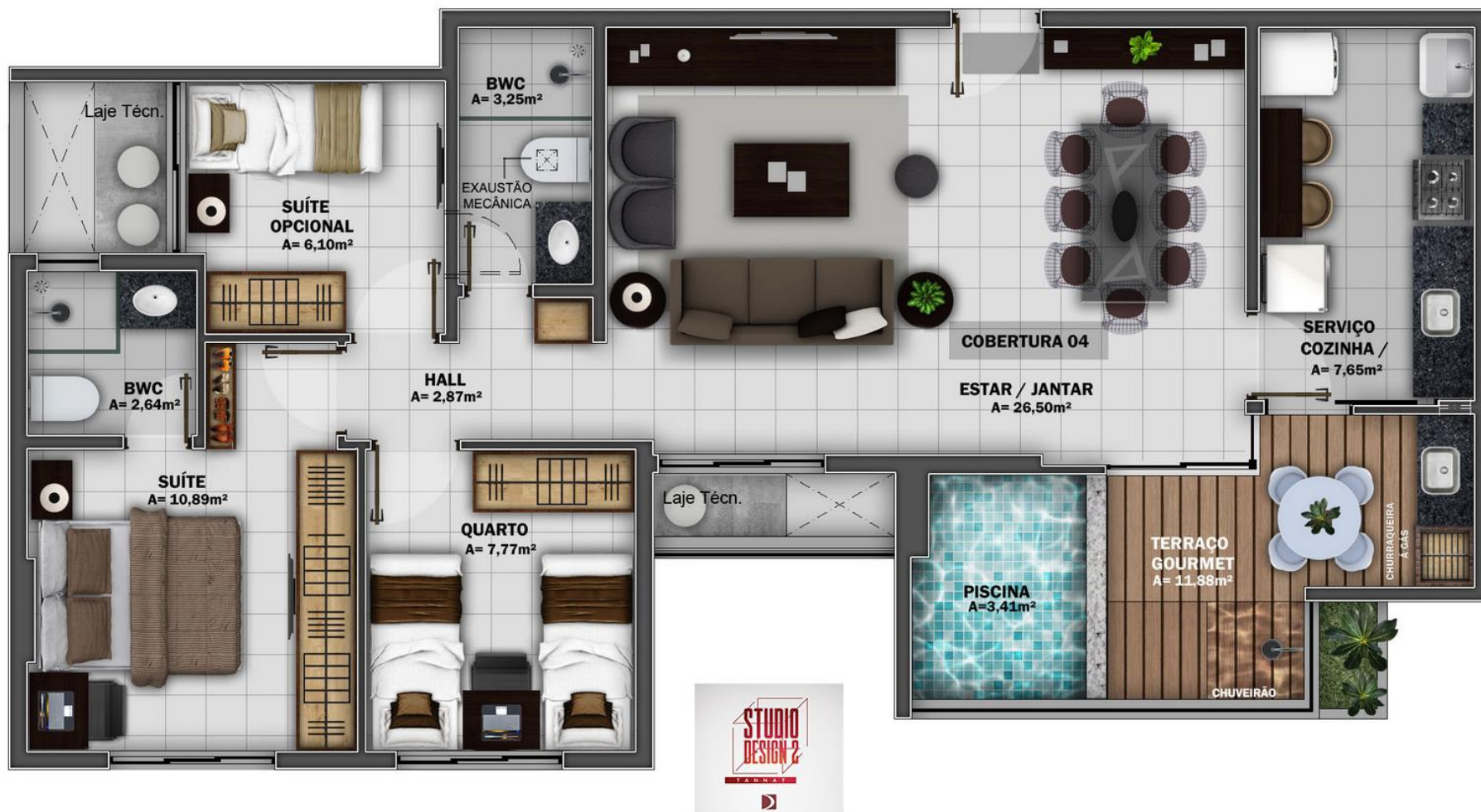
Figura 12 - Planta baixa dos Apartamentos Cobertura 04
