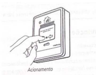
Figura 28 - Botoeira de incêndio
