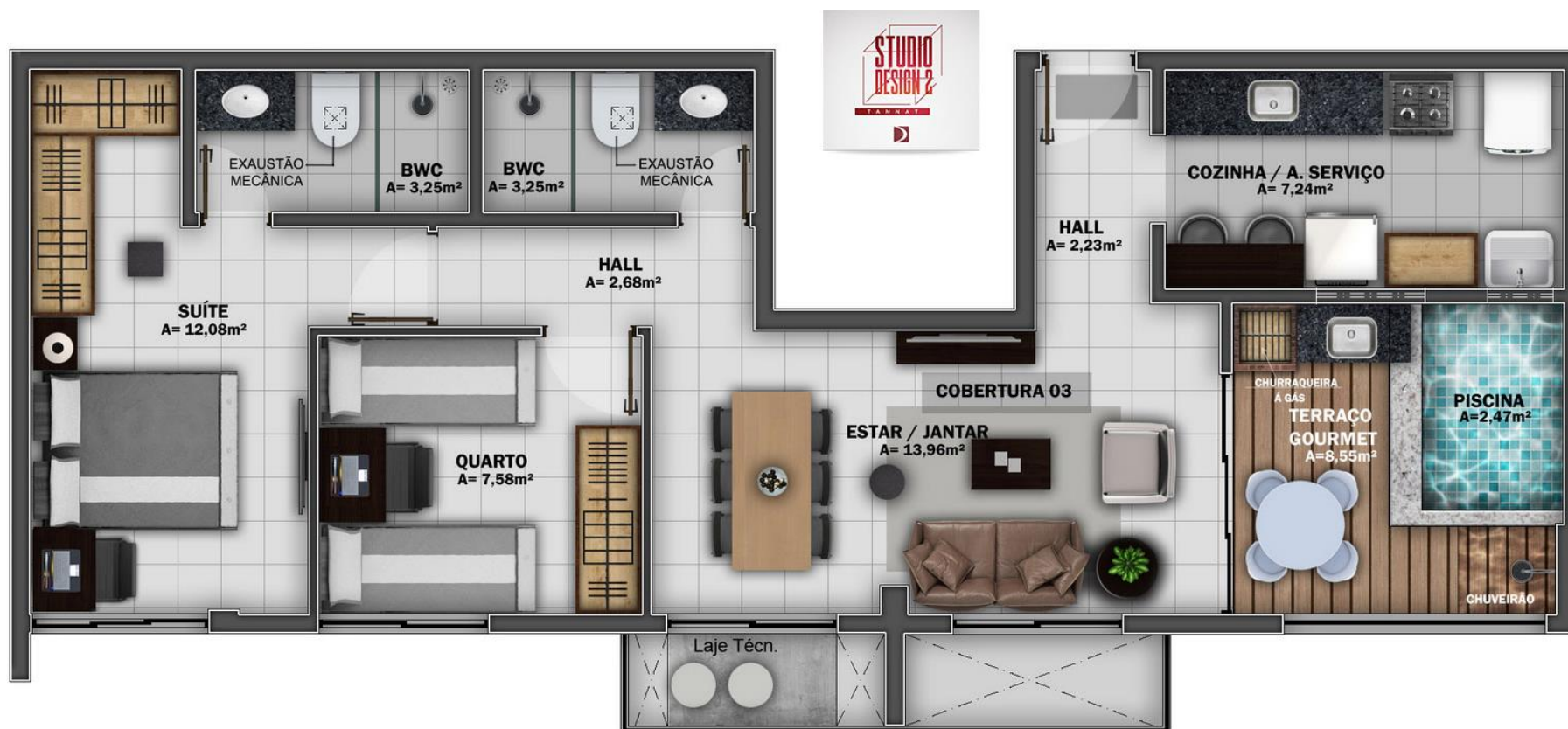
Figura 11 - Planta baixa dos Apartamentos Cobertura 03
