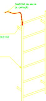
DETALHE DA INTERLIGAÇÃO DA ESCADA TIPO MARINHEIRO COM A MALHA DO SPDA DETALHE 6
